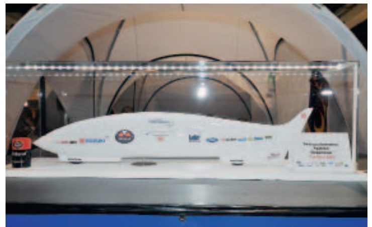
Von Pinguinen inspiriert: Der von Dr. Peter Maskus entworfene Acabion glänzt mit einem Cw-Wert von lediglich 0,08.
