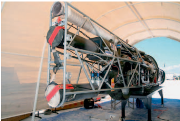
Gitterrohrgeflecht unter der Verschalung des Ack-Attack-Streamliners. In den beiden Rohren im Heck sitzen die Bremschirme.
