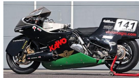
**Peter Scheepers fährt sonst Viertelmeile-Races. Die Turbo-Egli-Suzuki ist neu aufgebaut und drückte „mit wenig Ladedruck bei drittel-offenem Schieber“ 240 PS**
